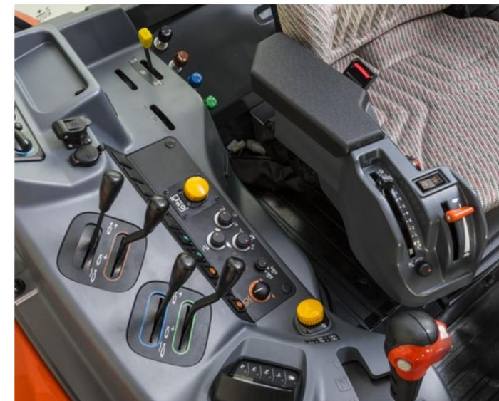
Sie sparen damit Zeit, weil Sie den Motor nicht auf die erforderliche Drehzahl runterdrosseln müssen, und werden von Ihrer eigentlichen Aufgabe nicht abgelenkt. Äußerst nützlich ist auch die Kubota Konstant-Drehzahlregelung. Der elektronische Regler hält die Motor- und Zapfwelldrehzahl konstant. In Kombination mit dem Automatik-Modus des Getriebes wird eine höhere Arbeitsqualität von Zapfwellengeräten erzielt. Der Einsatz einer Ballenpresse in hügeligem Gelände ist ein Paradebeispiel dafür.
